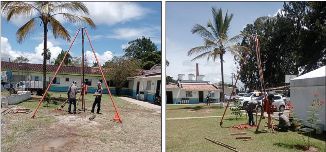
Figura 02. Detalle de proceso de exploración geotécnica en el predio objeto de estudio, Zona Urbana del Municipio de Yolombó - Antioquia.
